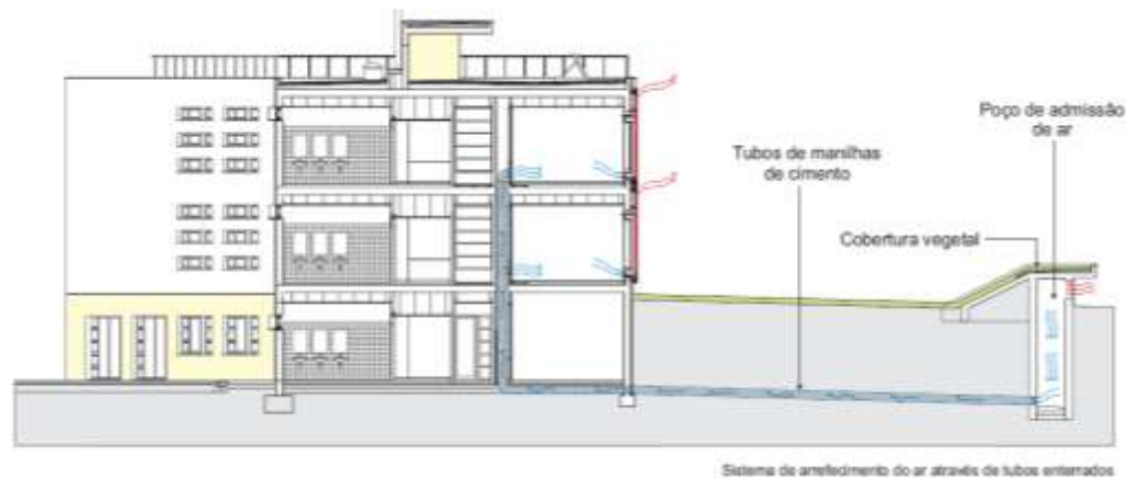
Figura 7.16 Sistema de arrefecimento pelo solo do Edifício Solar XXI. (Fonte: INETI, 2007)
